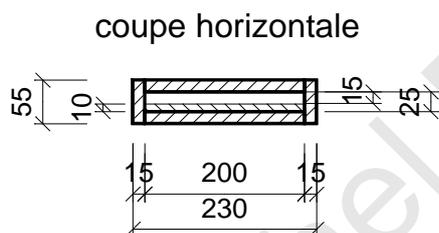
Les dimensions peuvent varier à condition de réduire à 15 mm le passage pour l'accès .
